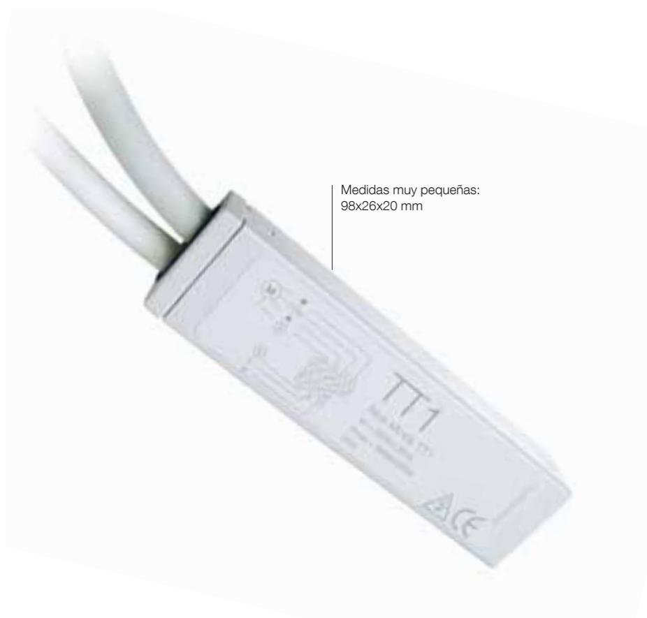
**Mindy TT1**, con receptor integrado 433,92 MHz con más de 4,5 mil billones de combinaciones. Autoaprendizaje de los transmisores Nice y los sensores climáticos Nemo y Volo S-Radio.
