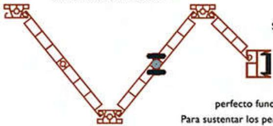
Sistema de articulación formado por perfiles totalmente fabricados de P.V.C. que aseguran un perfecto funcionamiento y duración. Para sustentar los perfiles utilizamos chapita metálica de 1,5 mm. de grueso.
